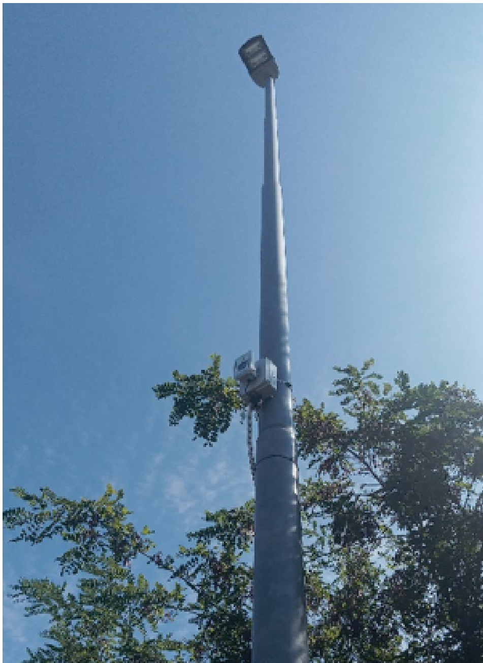
Senzorsko omrežje za promet in kakovost zraka v Novi Gorici: Teleram S2 – zunanji modul
