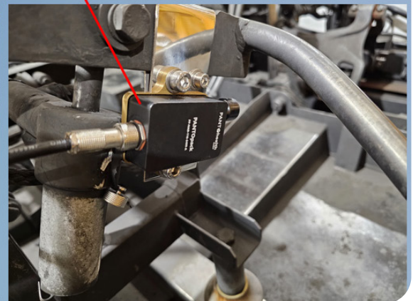
Obrázok 14: Senzorový systém nainštalovaný na pantografe električky na monitorovanie interakcie medzi vozidlom a trolejovým vedením.
