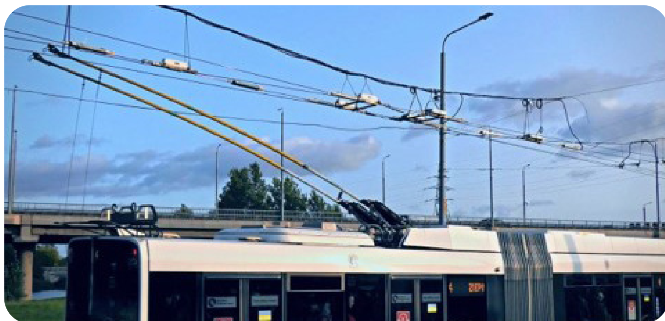
Obrázok 23: Trolejbusová trolejová výhybka používaná v sieti v Segedíne.
