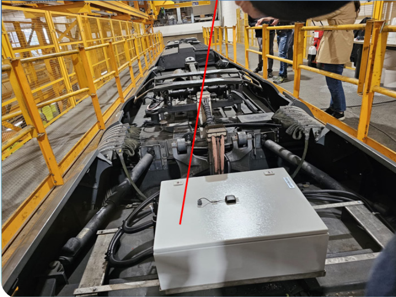
Obrázok 14: Senzorový systém nainštalovaný na pantografe električky na monitorovanie interakcie medzi vozidlom a trolejovým vedením.
