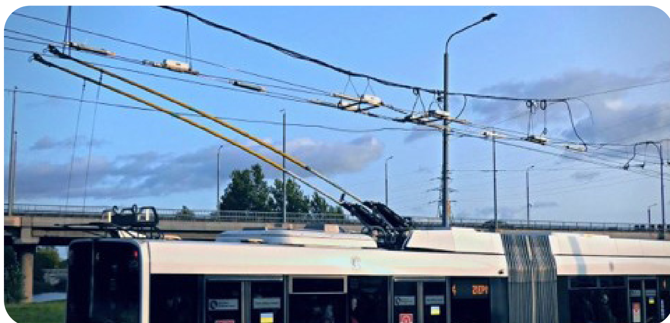
Slika 23: Trolejbusna nadzemna kretnica, uporabljena v omrežju Szeged.
