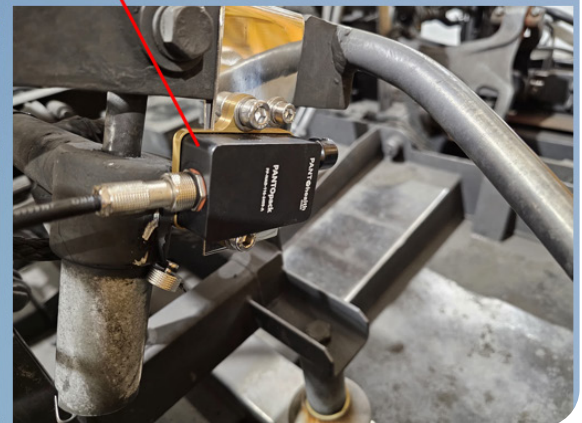
Rysunek 14: System czujnikowy zainstalowany na pantografie tramwaju do monitorowania interakcji między pojazdem a siecią trakcyjną.
