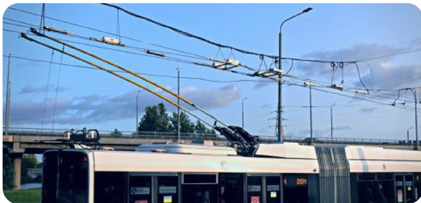
23. ábra: A szegedi hálózatban használt trolibusz-felsővezetéki váltó.
