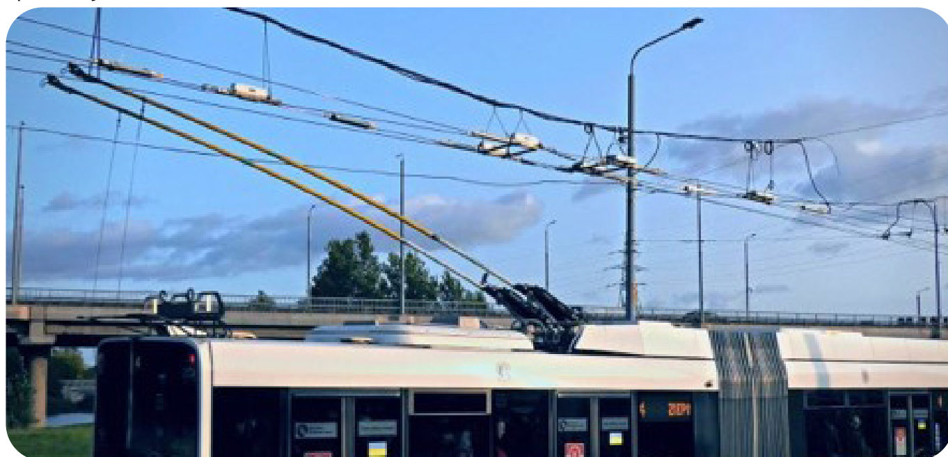
Slika 23: Trolejbusna nadzemna skretnica korištena u mreži Szegeda.
