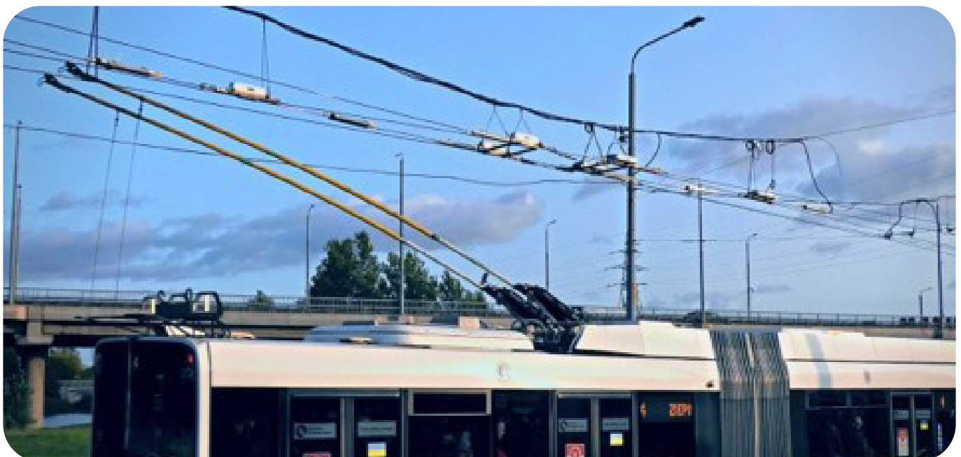
Abbildung 23: Im Netz von Szeged eingesetzte Trolleybus-Oberleitungsweiche.
