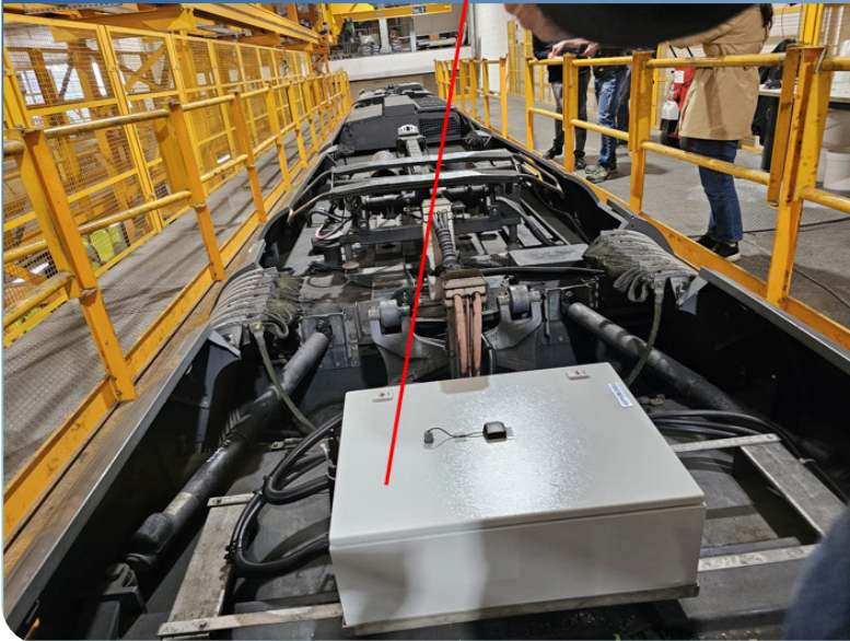
Obrázek 14: Senzorový systém instalovaný na pantografu tramvaje pro monitorování interakce mezi vozidlem a trolejovým vedením.
