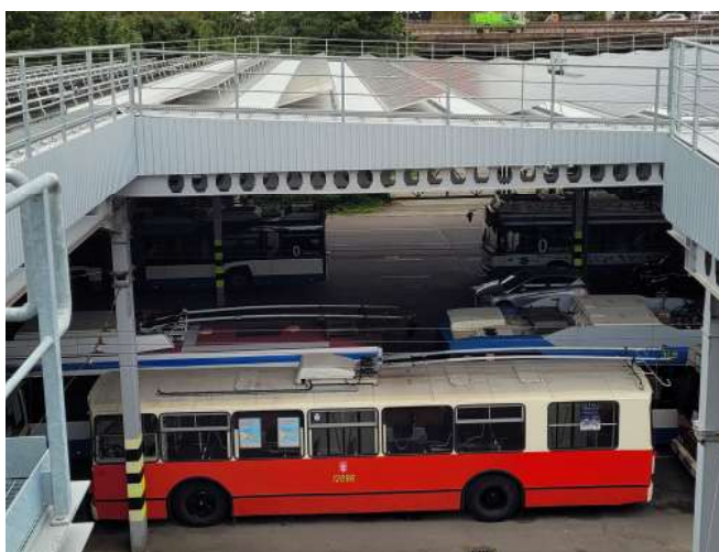
Figura 13. Impianto fotovoltaico che alimenta i filobus di Gdynia presso il deposito. Crediti: CE4CE
