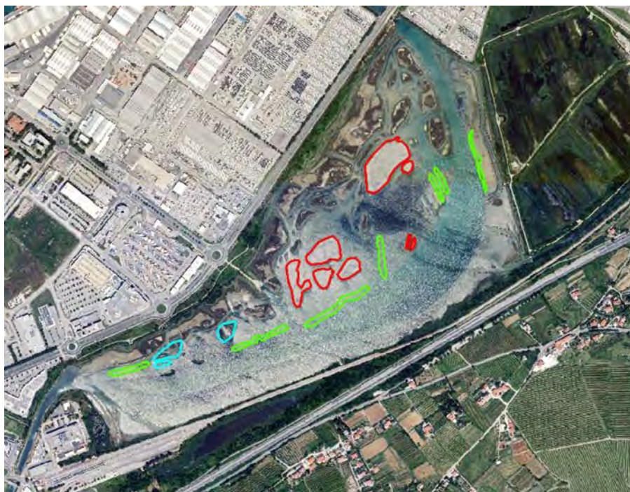
Slika 21: Prikaz predvidenih ukrepov znotraj območja NRŠZ. Rdeča obroba = obstoječe nadvišane umetne okopnitve, zelena obroba= predlagane nove linijske umetne okopnitve, turkizna obroba=predlagana območja za nadvišanje iz zagotovitev ustreznega višinskega gradienta za potencialni razvoj Natura 2000 habitatov.
